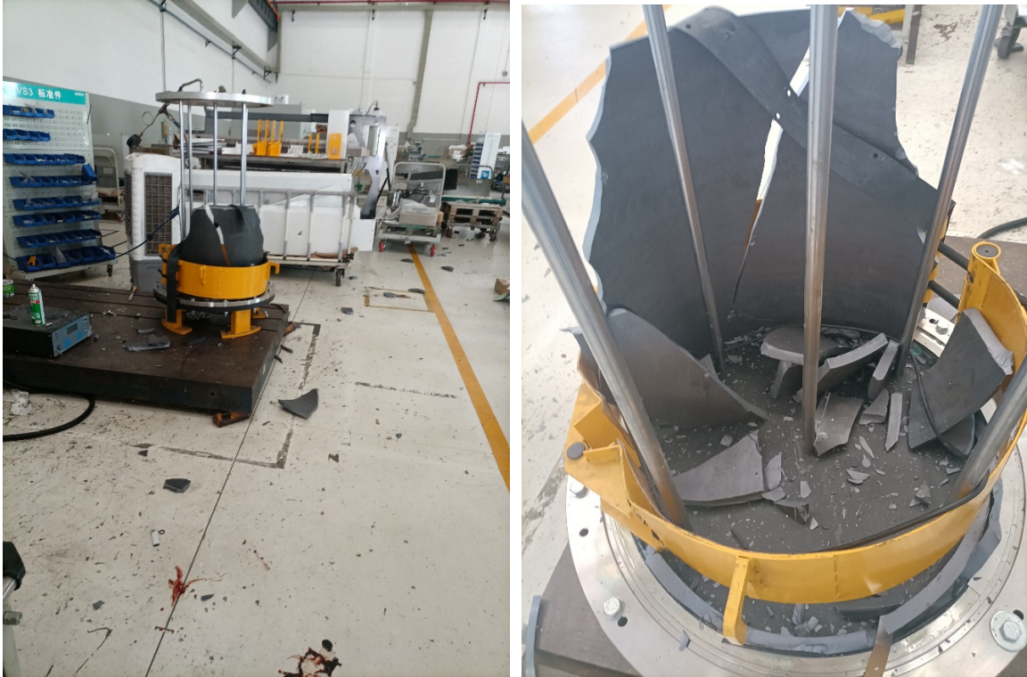
图 2 事发现场和爆裂的陶瓷内衬
