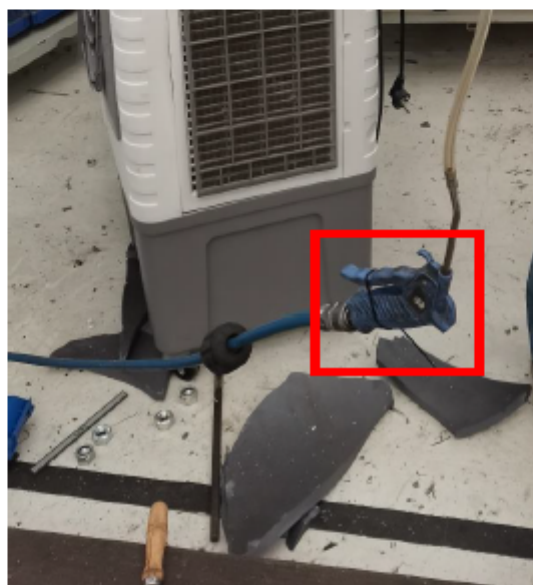
图4 自锁式尼龙扎带捆绑进气开关
