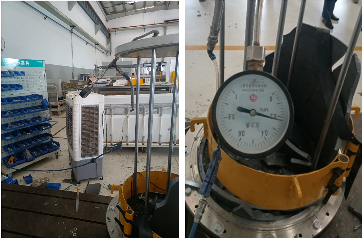
图 3 事发现场的进气管道和压力表
